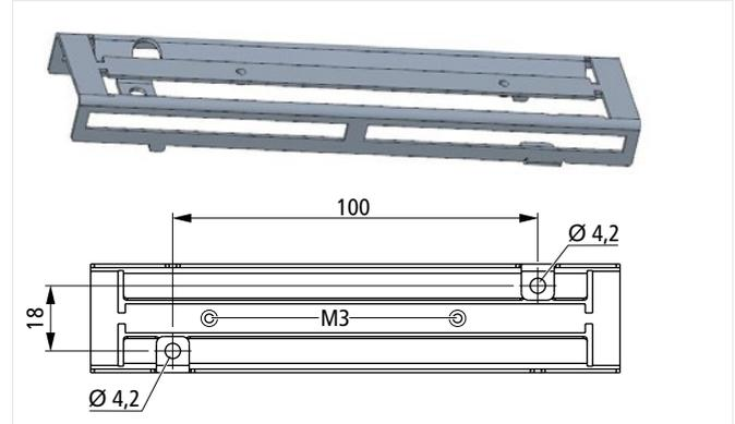
Abb. 3: Konsole FM 155 F mit Bohrmaßen in mm
