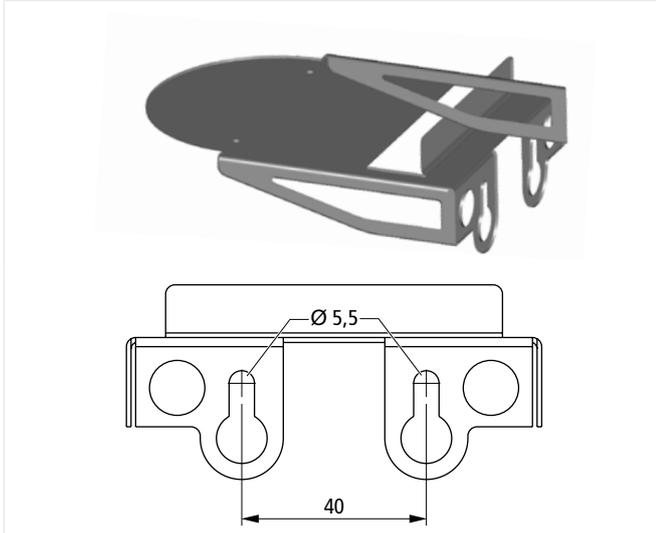
Abb. 1: Konsole 155-W mit Bohrmaßen in mm
