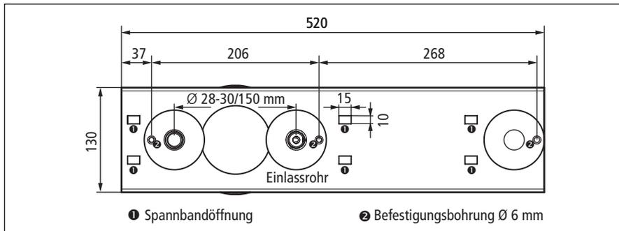
Die Montage des LRS 230V DIBt am runden oder eckigen Lüftungskanal kann sowohl mit Schrauben (Lieferumfang) als auch mit Spannbandern erfolgen.
