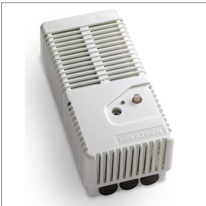
Feststellanlagen werden eingesetzt, wenn bewegliche Raumabschlüsse ständig oder zeitweise offen gehalten werden müssen, um einen reibungslosen Betriebsablauf zu gewährleisten. Das Netz- und Auslösegerät liefert die Betriebsspannung für Rauch- bzw. Thermoschalter und für Feststellvorrichtungen.
