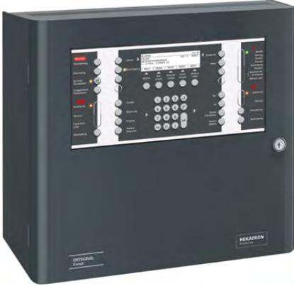
Überwachung der **Rettungswege** mit einer Brandmeldeanlage von Hekatron: Hier werden die akustischen und optischen Signalgeber zur Alarmierung manuell via Handfeuermelder sowie beim Auftreten von Rauch automatisch über die Brandmelderzentrale (Integral EvoX C) aktiviert. Darüber hinaus kann die in der Sächsischen Beherbergungsstättenbaurichtlinie geforderte Brandfallsteuerung der Aufzüge ausgelöst werden. Die Übertragungswege sind hier EN 54-konform überwacht.
