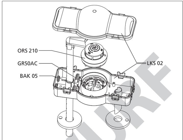
Abb. 1 Lüftungs Rauchschalter System LRS 02
