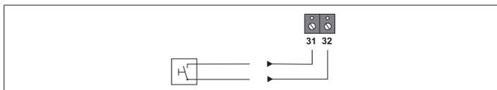
Abb. 38: Externer Resettaster angeschlossen
