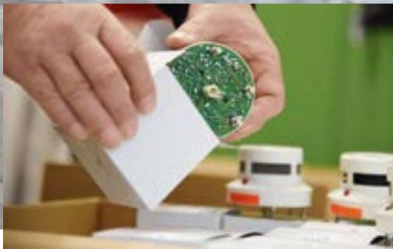
Der Austausch eines Melders ist schnell gemacht (links außen), die alten Melder werden danach im Gerätekarton an Hekatron zurückgeschickt (links).
