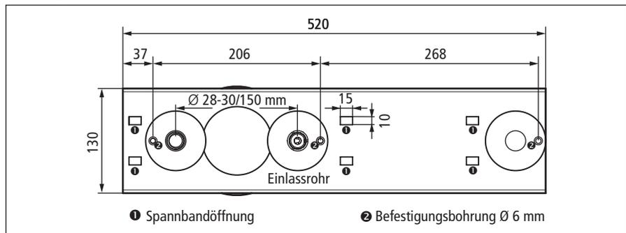
Die Montage des LRS 04 Ex am runden oder eckigen Lüftungskanal kann sowohl mit Schrauben (Lieferumfang) als auch mit Spannbändern erfolgen. Über die 3 Moosgummischeiben an der Unterseite der Montageplatte, passt sich der LRS 04 Ex an Unebenheiten am Kanal an. Somit ist eine bestmögliche Abdichtung des Lüftungskanals gewährleistet. Für größere Unebenheiten liegen 3 weitere Moosgummischeiben bei.
