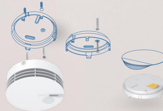
Bei vorhandenem Bohrlloch schnelle Montage ohne weiteres Werkzeug – mit dem neuen Daumenstecknagel.
